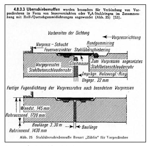
Auszug aus Sonderdruck Betonkalender 1967 Die Überschiebmuffe bei großen Rohrdurchmessern (ab DN 1400)
