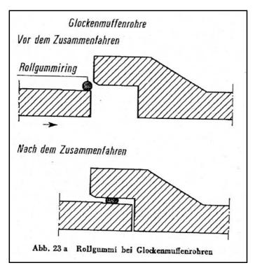
Auszug aus Sonderdruck Betonkalender 1967 Der Rollgummi an Glockenmuffenrohren
