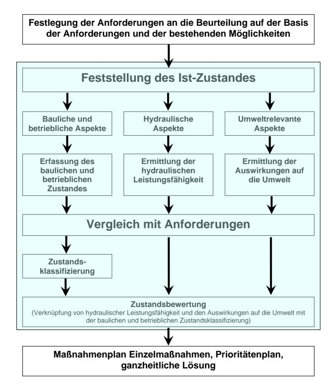
Vorgehensweise bei der Zustandsklassifizierung und Zustandsbewertung nach baulichen und betrieblichen Aspekten, der hydraulischen Leistungsfähigkeit und den Auswirkungen auf die Umwelt nach ATV-M 149
